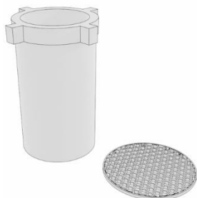
Cylinder do badania czasu rozpadu w aparacie BJKSN-13
