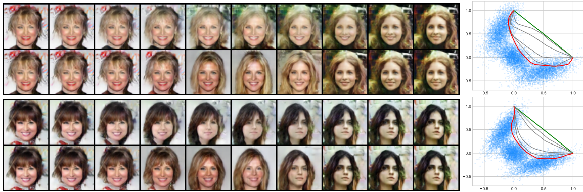
Rysunek 14: Przykładowe interpolacje w modelu DCGAN trenowanym na podkowie w \mathbb{R}^8 . W każdej parze górny rząd reprezentuje ścieżkę liniowej interpolacji, podczas gdy dolny pokazuje wynik proponowanej procedury optymalizacyjnej. Po prawej stronie podane są odpowiednie projekcje rozkładu na przestrzeni ukrytej (niebieskie kropki), interpolacje liniowe (na zielono) i nasze (linie czerwone, szare linie pokazują pośrednie etapy optymalizacji). Rysunek pochodzi z pracy [A4].
