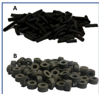
Rys. 2 Katalizator kobaltowy na nośniku Al 2 O 3 w postaci wytłoczek (A) oraz pierścieni Raschiga (B).
